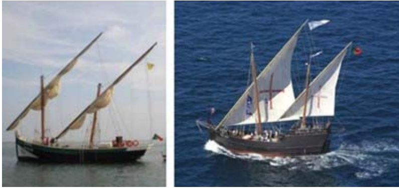
Figura 5 - Comparação da silhueta: casco e vela latina no Caique de Olhão (esquerda) e na Caravela “VERA CRUZ” (direita). Fonte: Fotografia de José Manuel Carmo, desenhador Naval do Estaleiro Samuel & Filhos de Vila do Conde, construtor da réplica, obtida no Cabo Carvoeiro, em Peniche, em 2000. Arquivo Museu Municipal de Esposende.
