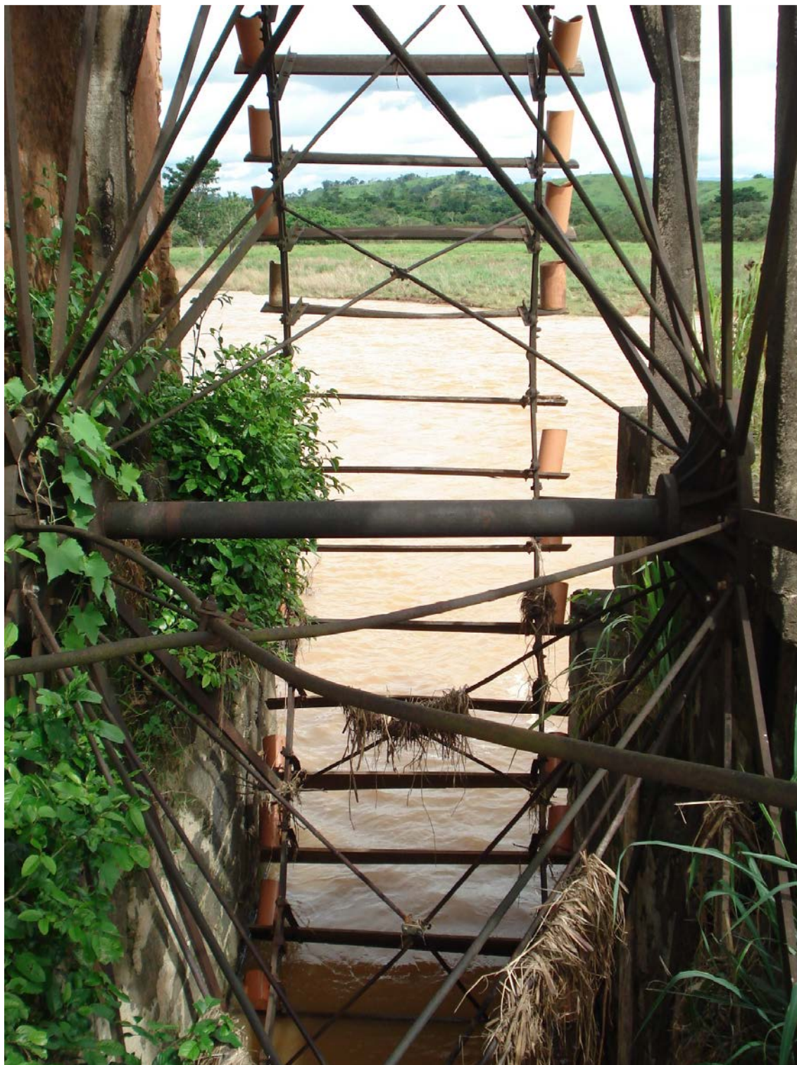
Figura 8. Detalhe do alcatruzes da d'água, Fazenda Quartéis; Cambuci, RJ. Fonte: Foto da autora.
